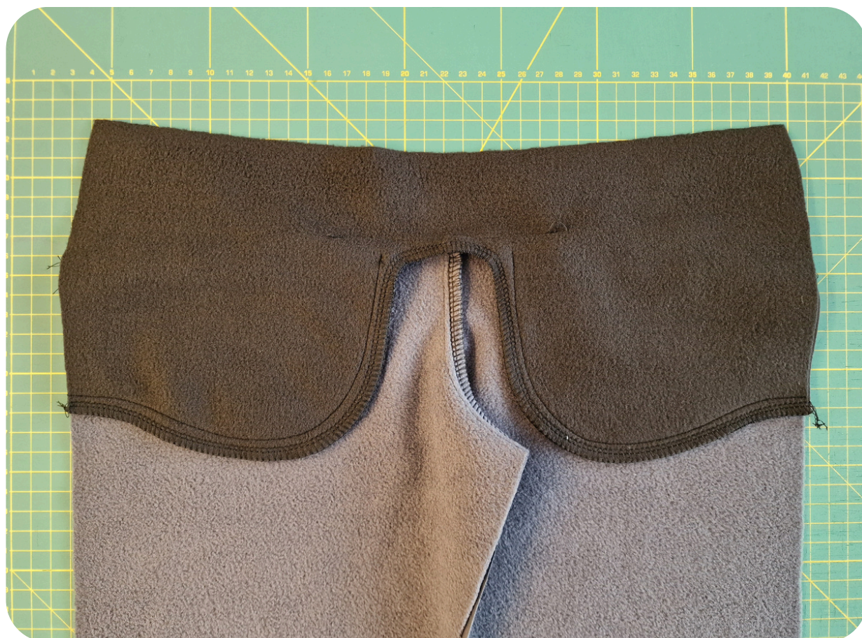
16. A poté kasové vácčky začistíme overlockem v jedné operaci viz. foto
